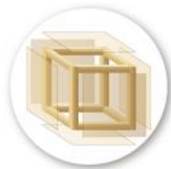
点と面で支える モノコック構造
